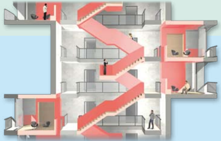
Eine freistehende Treppenkonstruktion erstreckt sich vom Untergeschoss bis in das oberste Stockwerk des BIOQUANT-Gebäudes.
